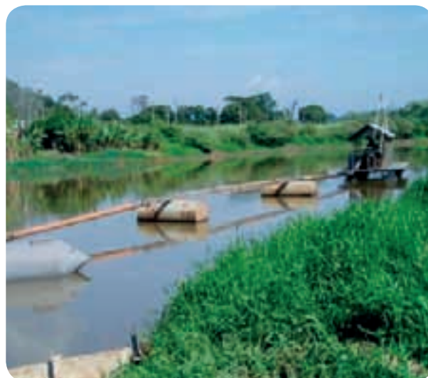
Figura 14 – Equipamentos utilizados na extração de areia ("areiais") do leito do rio Paraíba do Sul e afluentes.
